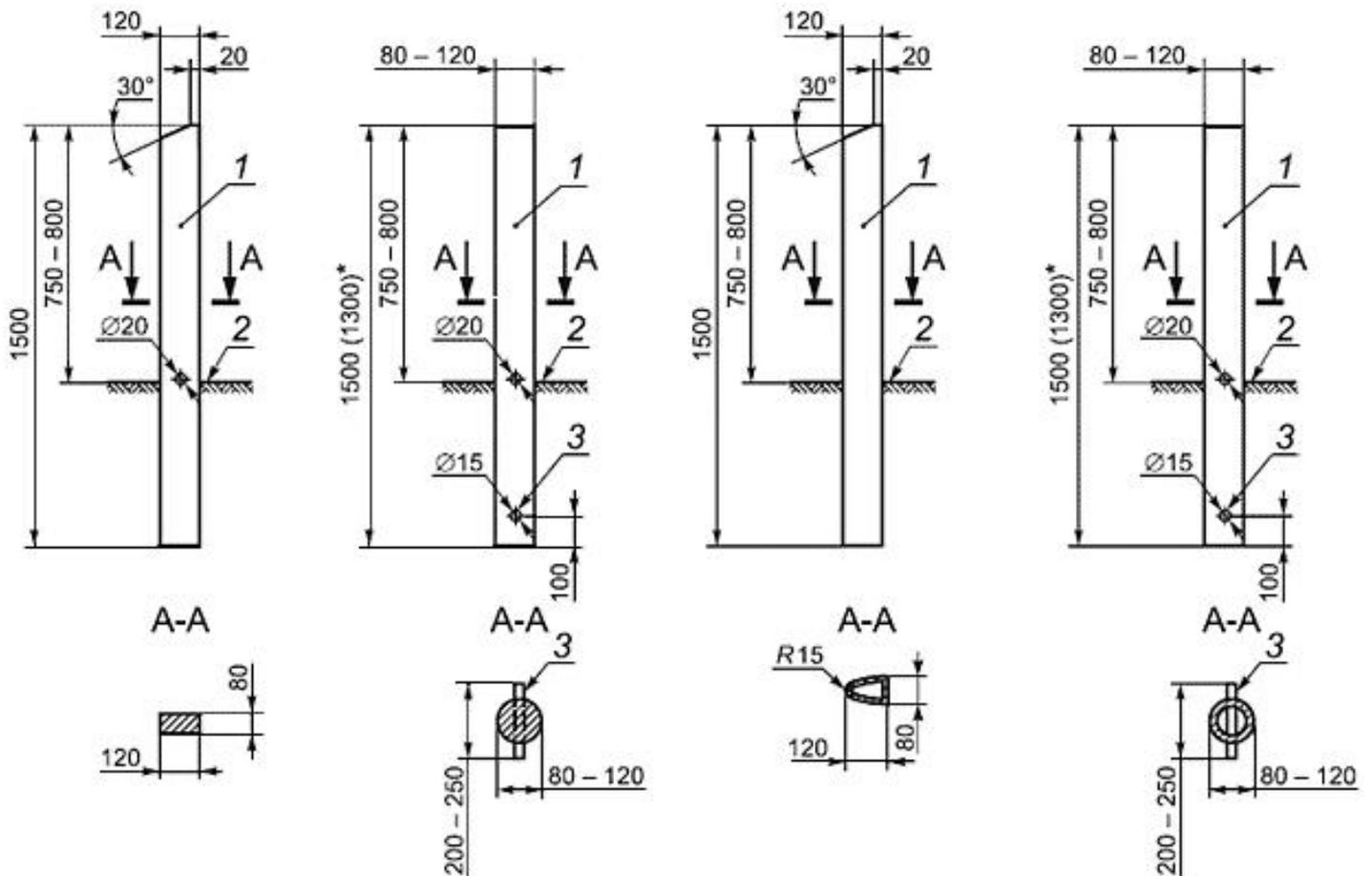
1 - корпус столбика; 2 - поверхность грунта; 3 - анкерное устройство
