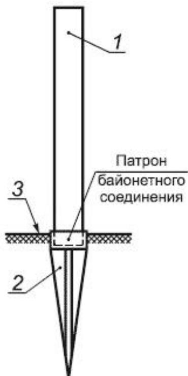
1 - корпус столбика; 2 - удерживающее устройство; 3 - поверхность грунта
